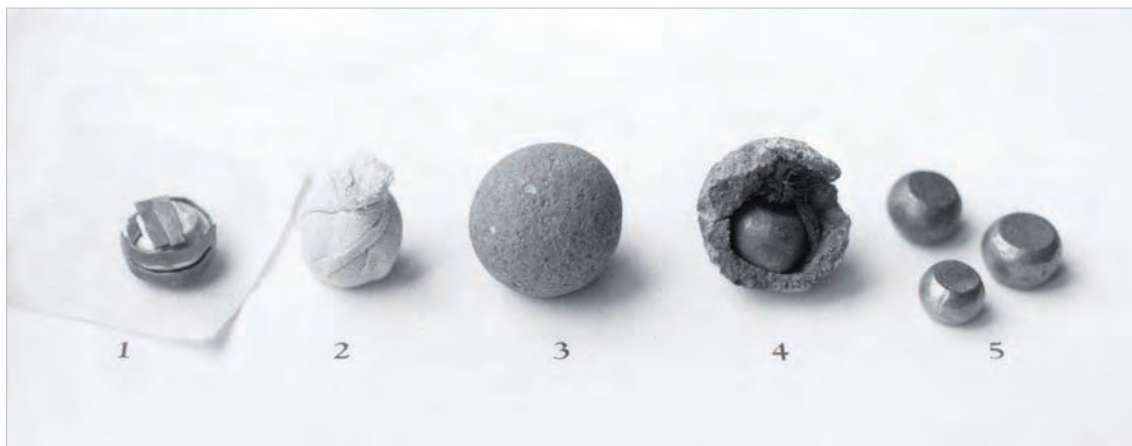
Figur 35. Tillverkning av bipolära järnvikter. Det smidda järnämnet knyts tillsammans med lod av kopparlegering in i ett tygknyte som bakas in i en lerkula. Lerkulan läggs i ässjan en stund vid 1000-1100 grader C, varvid lodet smälter och lägger sig kring järnkärnan. Då kulan svalnat kan den krossas och den färdiga vikten tas ut.
