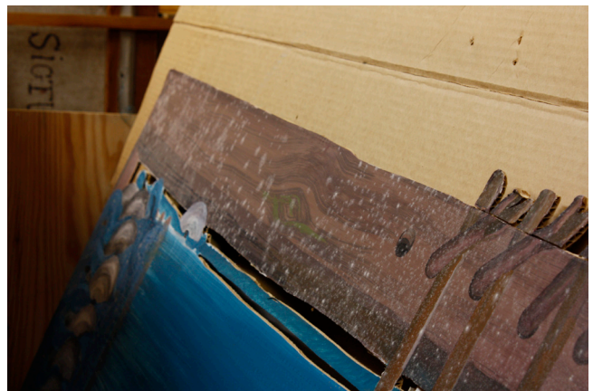
Fig. 32. Mögelpåväxt på utställningsmaterial (kartongskiva). I princip bara de partier som är bemålade med en brun färg är angripna
