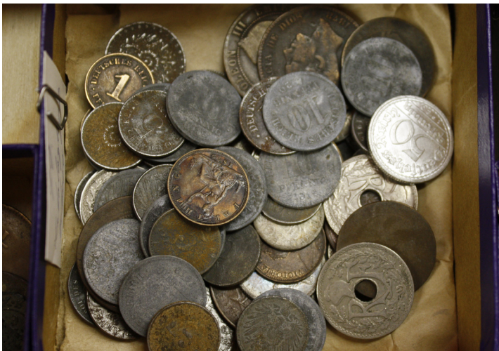
Fig. 27. Vitaktig/dimmig troligen bly- eller tennkorrosion på mynt
