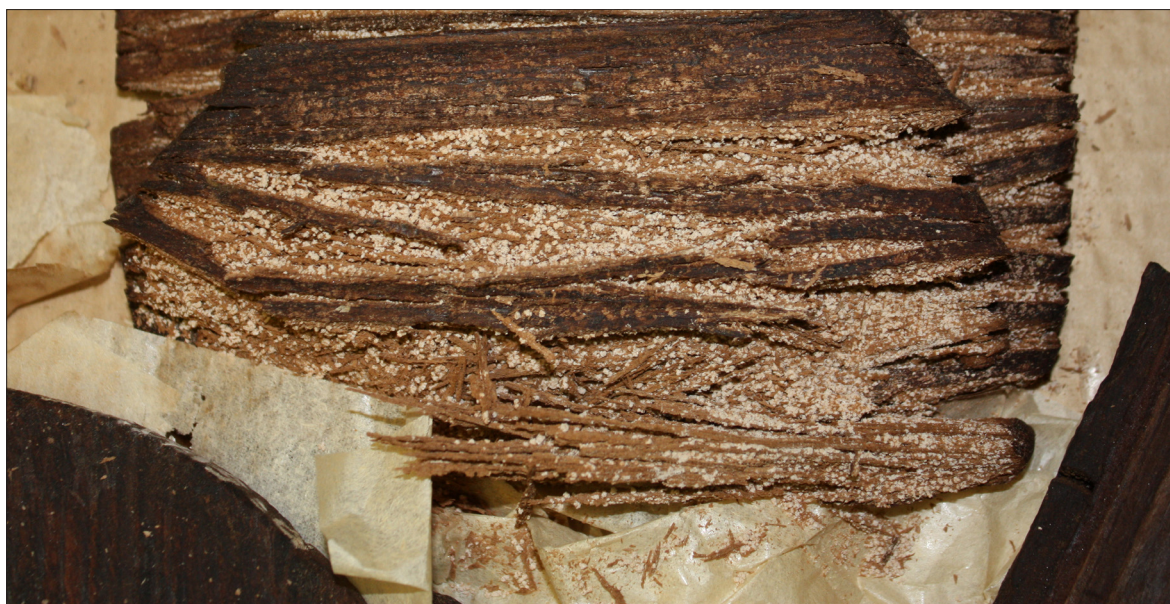
Fig. 21. Närbild på ett av de nedbrutna träföremålen. Det finns vita kristaller i trämjölet
