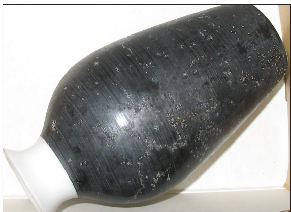
Fig. 36. Kristallina utfällningar på modern keramik
