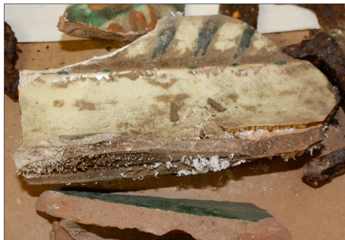
Fig. 22. Glaserad keramikskärva med saltutfällningar som spränger bort ytskiktet
