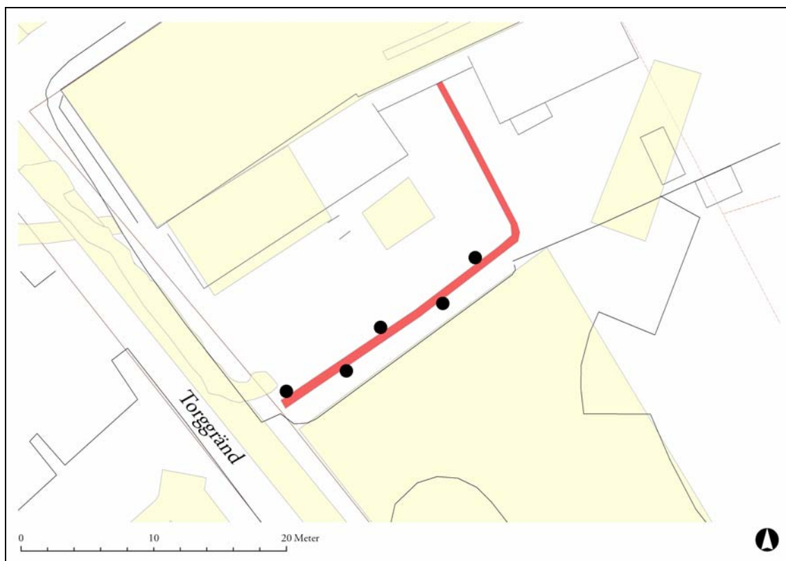
Figur 1 Planritning över det undersökta schaktet i kvarteret Koppardosan 2, Sigtuna. De svarta punkterna motsvarar placeringen för borrhålen.
