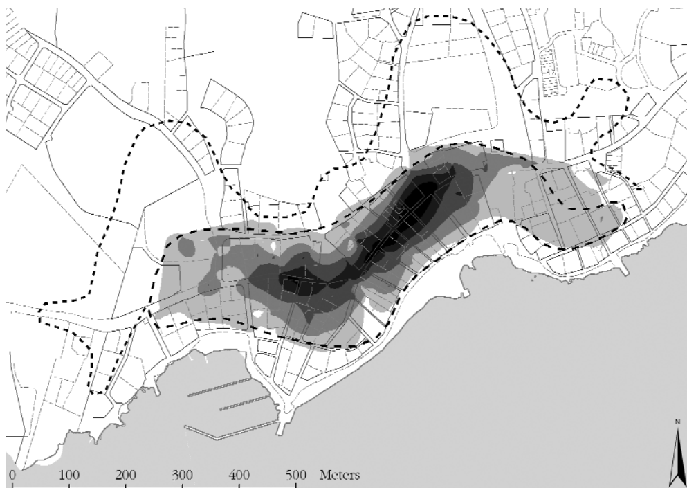
Fig. 5. Kulturlagrens tjocklek i Sigtuna med 0,5 meters intervall. Figuren är framtagen genom interpolering i Arc View. Uppgifterna kommer från höjddatamater och databeräkningen kan ge en något annorlunda bild än en liknande, manuellt gjord figur.
