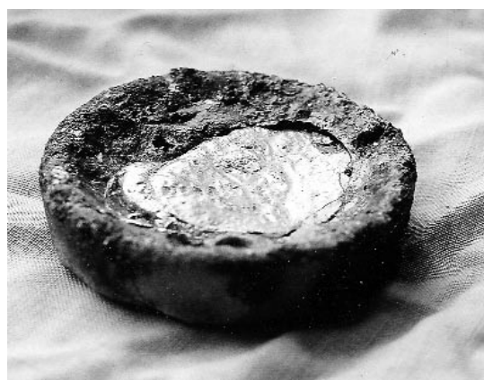
Fig. 8. Kärn 1 efter utfört experiment. Bly/silver-smältan har fått stelna i kärlet på ett tidigt stadium i processen, för att demonstrera smältans läge i den djupt nederoderade depressionen. Foto författaren.
