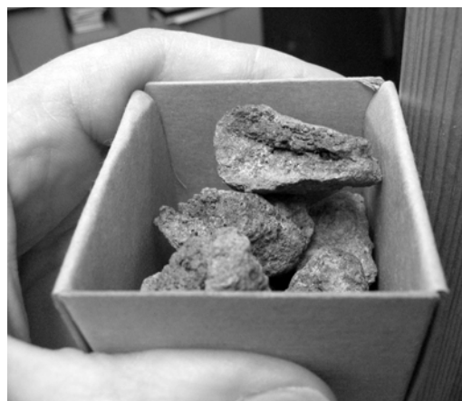
Fig. 2. Hearth material (litharge cakes) from silver refining hearths is heavy, due to a high lead content, grainy and sometimes contains tiny bone fragments, grey with a green zone close to the surface and slightly bowl-shaped in section. 12th century litharge material from Trädgårdsmästaren, Sigtuna (find no 5952). Photo by the author. – Hårdmaterial från silvveraffinering är påtagligt tungt p.g.a ett högt blyinnehåll, grått och kornigt med ibland synliga smärre benfragment, lätt skålformat i profil och med en grönaktig zon närmast ytan.
