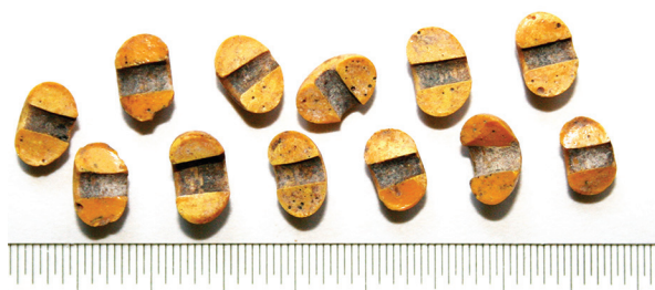
Figur 5. Brottytorna visar tydliga mönster av porer/blåsor, vilka utesluter att någon skulle kunna pusslas ihop med en annan ur samlingen. Skalan visar halvmillimetrar.
