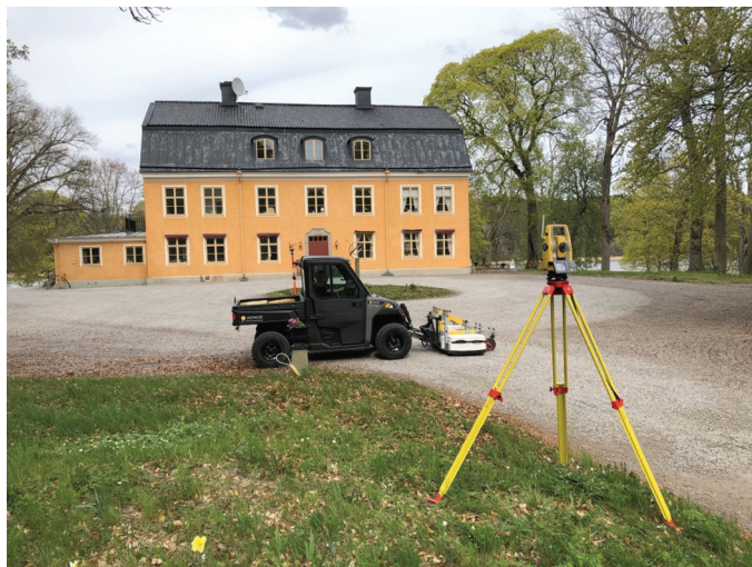
Figur 2. Motoriserad georadar från Astacus i arbete vid Signhildsberg i maj 2019. Foto: Olof Heimer.
